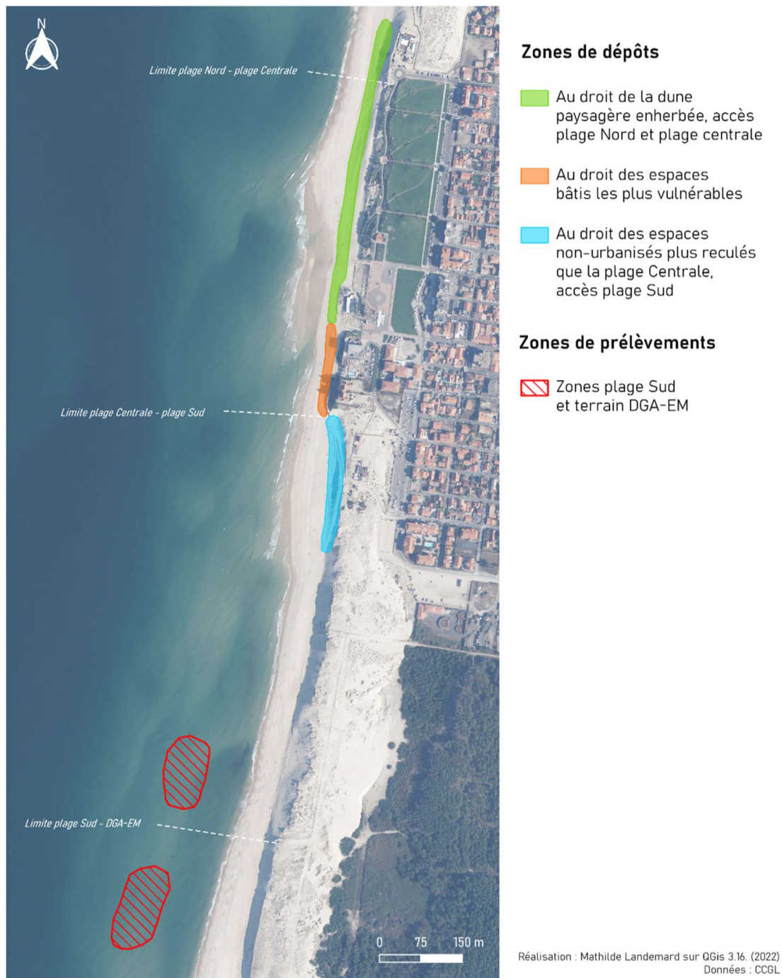
Document 17 : localisation des opérations de transferts sédimentaires mécaniques, avec zones d'emprunts et zones de dépôts ©CCG, 2022
