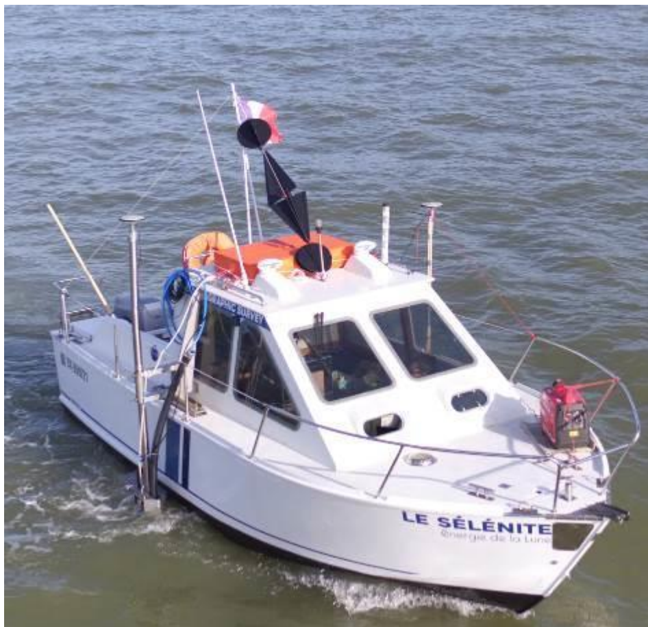
Figure 4 : Photographie de la vedette hydrographique Le Sélénite en opération de levé bathymétrique (crédit photographie : Energie de la Lune)
