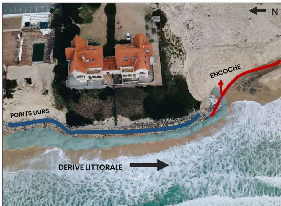
Figure 8 Effet tampon des rechargements (bleu), et effet accélérateur d'érosion bien perceptible des encoches (CdC des Grands Lacs, d'après France Info, 2021 : cliquez ici )
